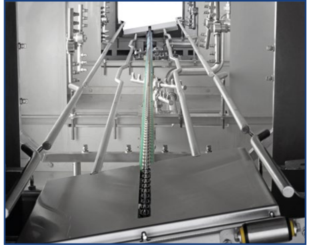
Schräge / versetzte Behälterführung - keine Spritzschatten
