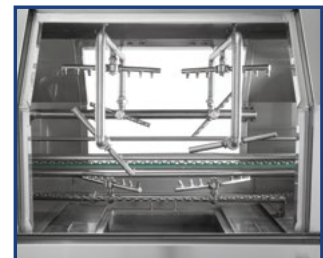
Optimale Zonenlänge - wenig Wasser/Chemie- Verschleppung
