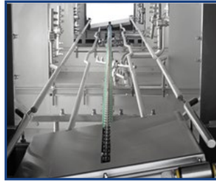
Schräge / versetzte Behälterführung - keine Spritzschatten
