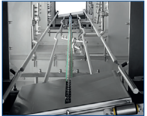
Schräge / versetzte Behälterführung - keine Spritzschatten
