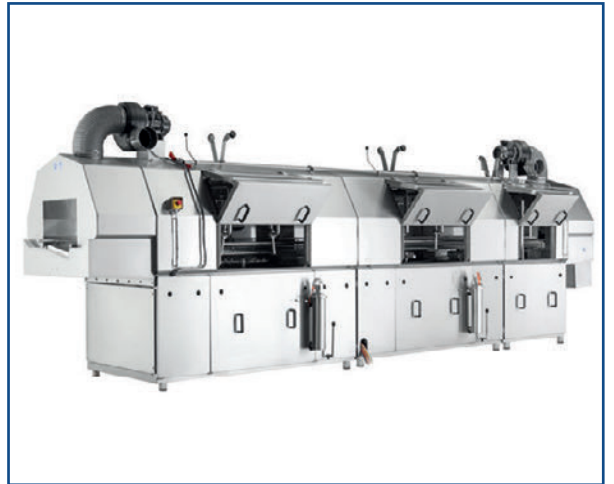
CM Baureihe, Türen nach der Reinigung in Trocknungsstellung
