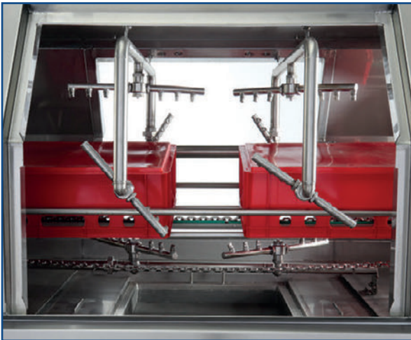
Reinigungsrotoren der Waschzone
