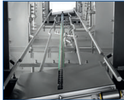
Bild.17 Schräge / versetzte Behälterführung - keine Spritzschatten
