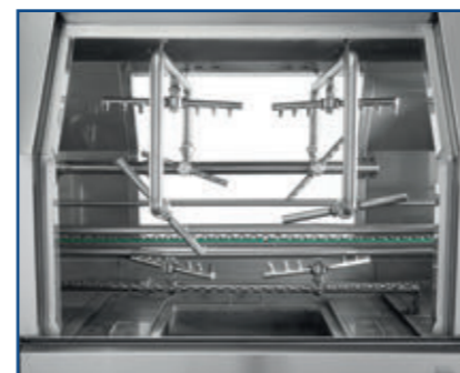
Bild.23 Optimale Zonenlänge - wenig Wasser/Chemie-Verschleppung
