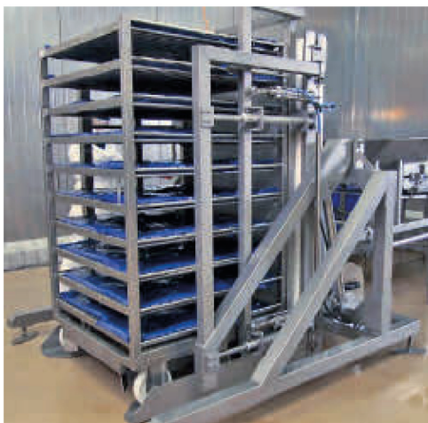
Foto 10: Swing-Loader für Großbehälter und Regalwagen
