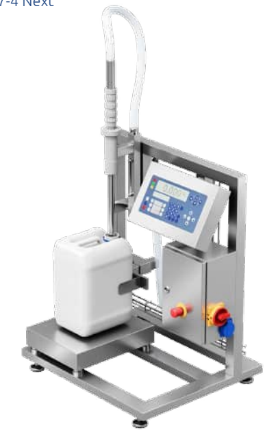
Bild.84 Chemie Umfüllanlage von Groß- in Kleingebinde
