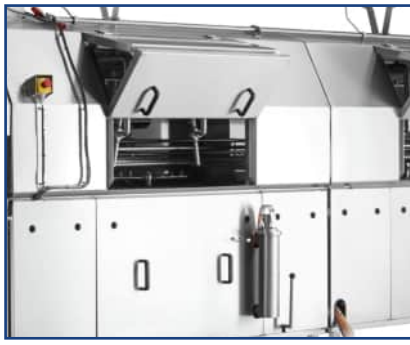
Bild.15 2-Phasen Türöffnung – Trocknungsstellung
