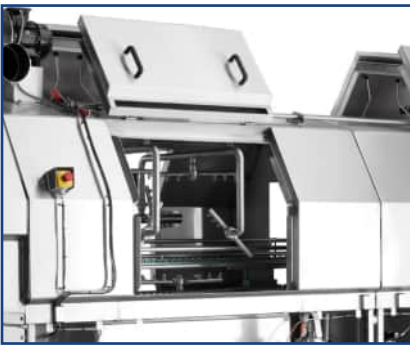
Bild.14 2-Phasen Türöffnung – Reinigungsstellung
