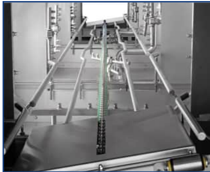
Bild.07 Schräge / versetzte Behälterführung - keine Spritzschatten
