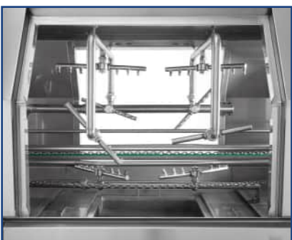
Bild.13 Optimale Zonenlänge - wenig Wasser/Chemie-Verschleppung
