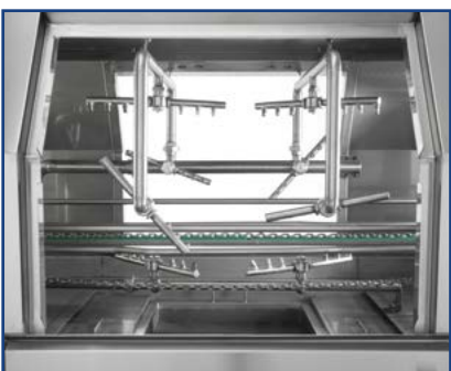
Bild.13 Optimale Zonenlänge - wenig Wasser/Chemie-Verschleppung
