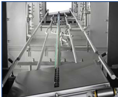
Bild.07 Schräge / versetzte Behälterführung - keine Spritzschatten
