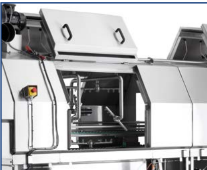
Bild.14 2-Phasen Türöffnung - Reinigungsstellung
