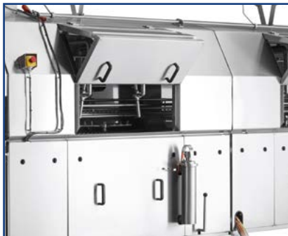
Bild.15 2-Phasen Türöffnung - Trocknungsstellung
